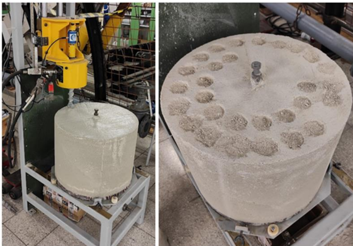
Rys. 5 Stanowisko z próbką przed badaniami i próbka po wykonaniu badań
